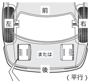
底面の取り付け方向レバー
