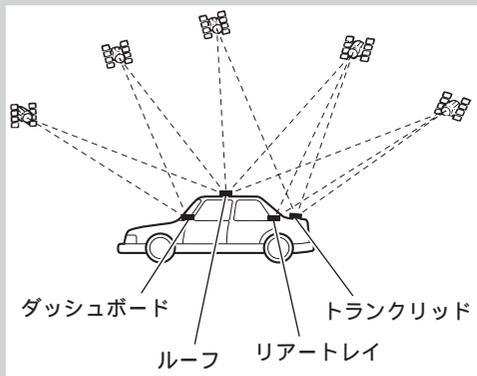
GPSアンテナを車内に取り付ける場合は、必ず付属の金属シートを使用してください。使用しないと、十分な受信感度が得られなくなります。
