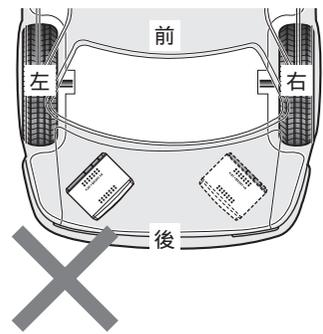
取り付け方向レバーは、矢印が進行方向を指す方に切り換えます。
