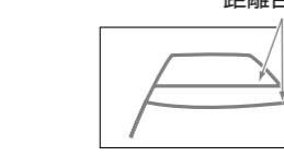
距離目安線は、平らな路面に対しての距離の目安を示しています。そのため、上り坂が後方にあるときには、実際の距離より手前に距離目安線が表示されます。例えば、上り坂に障害物があった場合は、実際より遠くに見えるようになります。同様に距離目安線と実際の路面上の進路にも誤差が生じます。
