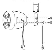
2. スピーカー本体の金具とワイヤーを逆にして、はずしたネジを使用し締め付けます。 (締め付けトルク: 15 kqf·cm~20 kqf·cm)
