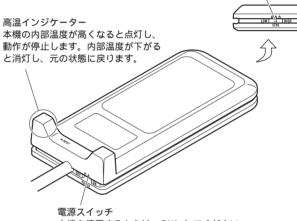
本機を使用するときは、ONにしてください。 メインユニットの電源ON/OFFに連動して、自動的 に本機の電源がON/OFFします。
