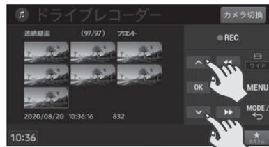
カメラ切換 にタッチすることにより、サムネール表示をフロント⇄リアに切り換えます。
