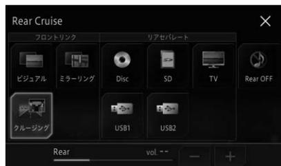
「クルージング」選択時はリアモニターにフロントカメラで取り込んだ前方映像と下記のAR表示が出力されます。
