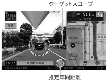
前方車両までの車間時間が短い場合は、ターゲットスコープと推定車間距離が黄色で表示されます。
