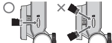
⚠ microSD カードを斜めに挿入しないでください。破損の原因になります。
