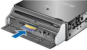
CF型カード挿入口にメモリーカードまたは通信カードを差し込む
