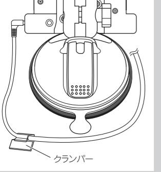
● シガーライター電源ケーブルの振動により、コネクタ部の接触不良を防止する為に、イラストの様にクランパーを貼り付けてください。
