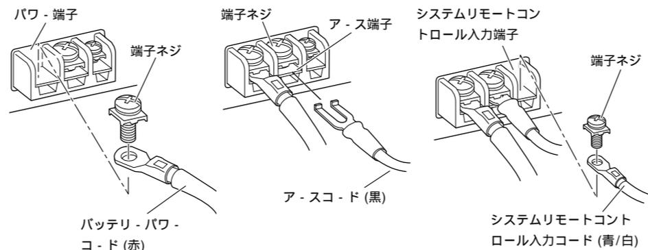
バッテリーなどの位置によって、高温となる場所にバッテリーパワーコードを配置してはならない場合は、RD-226 (別売) に付属のコレゲートチューブでバッテリーパワーコードを保護してください。
