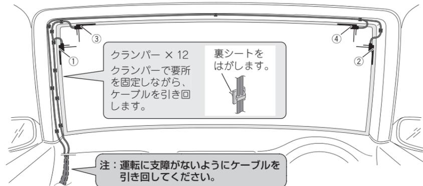
(※「電源コード、フィルムアンテナの接続」)
