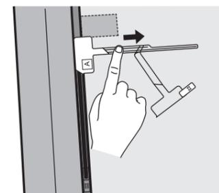
注：十分に汚れ、油膜、水分を拭きとってから貼り付けてください。また、真冬に車内が温かくなると、窓ガラスが結露しますので、十分に乾燥させてからエレメントを貼り付けてください。
