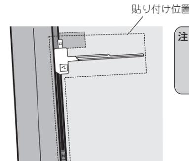
注：十分に汚れ、油膜、水分を拭きとってから貼り付けてください。また、真冬に車内が温かくなると、窓ガラスが結露しますので、十分に乾燥させてからフィルムを貼り付けてください。
