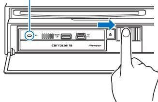
エンジンスイッチがON（本機の電源がON）の状態ではブレインユニットロックレバーをスライドすると、ブレインユニット前面のブレインユニットPOWERランプが点滅を始めます。点滅が終了し、ランプが消灯したらブレインユニットを取り出すことができます。
