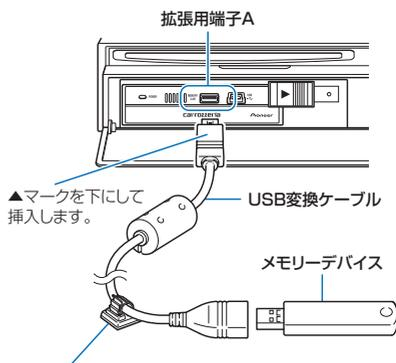
付属のクランパーを使用して、USB変換ケーブルをコンソールなどに固定します。
