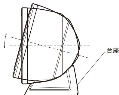
■ CST ドライバーの角度を調整する場合は、取付金具から一度外し、取付固定ネジを緩めて調整してください。
