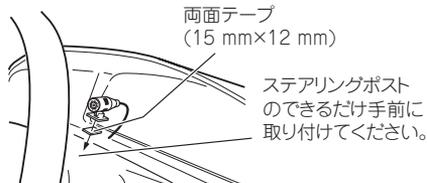
市販のクランパーなどで要所を固定しながら、運転操作に支障がないようにマイクコードを引き回します。
