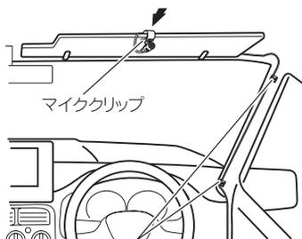
市販のクランパーなどで要所を固定しながら、運転操作に支障がないようにマイクコードを引き回します。
