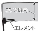
エレメント下端 (透明部含む) がガラス開口部の実長の20%以内に納まるように貼る
