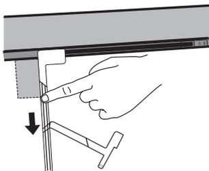
注：十分に汚れ、油膜、水分を拭きとってから貼り付けてください。また、真冬に車内が温かくなると、窓ガラスが結露しますので、十分に乾燥させてからエレメントを貼り付けてください。
