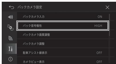
**LOW**: 接続状態画面 (☞ 45 ページ) で、シフトレバーをバックに切り換えたとときに「バック信号」の表示が [LOW] になる車両の場合はこちらを選びます。
