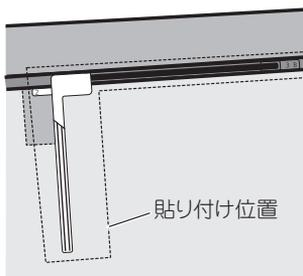
注：十分に汚れ、油膜、水分を拭きとってから貼り付けてください。また、真冬に車内が温かくなると、窓ガラスが結露しますので、十分に乾燥させてからフィルムを貼り付けてください。
