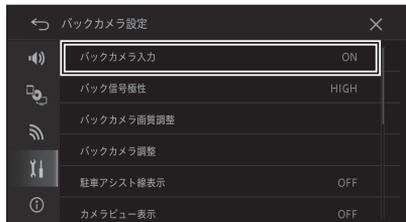
**4** **バック信号極性**にタッチしてカメラの極性を選択する
