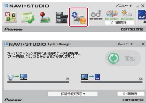
2分割転送の1枚目SDメモリーカード内のデータを削除する場合は、カーナビゲーション本体にて2枚目の更新完了後に、カーナビゲーション本体に1枚目のSDメモリーカードを挿入してください。(ナビ画面上は特に何も反応がありませんが、更新完了の状態をSDメモリーカード内に書き込んでいます。)
