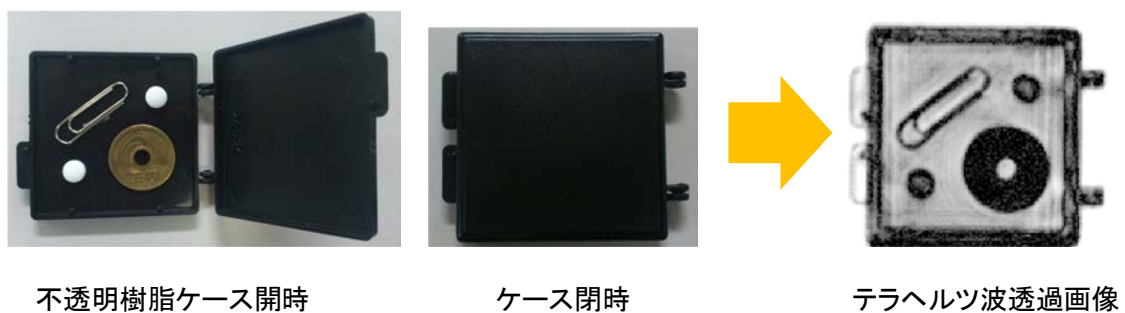
写真-4 不透明樹脂ケースの透過像
