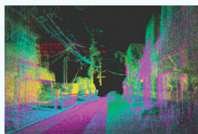
LiDARシステムで生成した3次元点群地図データ
