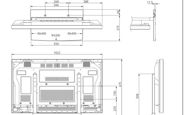
床に固定する際のねじは、M6、長さ20mm以上のものを使用してください。
