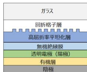
図4 白色有機EL素子基板構成
